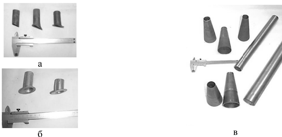
Рис. 6. Трубные переходники с наклонным фланцем (а – медь М1; б – сплав Д16), полученные неравномерной раздачей, и сопла конические (в) без фланца из стали 12Х18Н10Т
